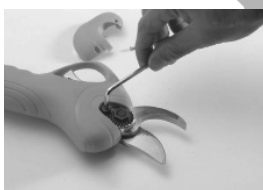
2. Odstranite vijake iz zaponka za pritrditev matice rezila (ta korak je ključnega pomena).
