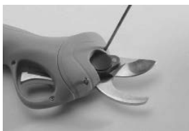
1. Odkręć śruby za pomocą śrubokrętu i otwórz pokrywę.
