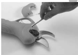
2. Retirer les vis de la écrou de lame boucle de retenue (cette est critique).
