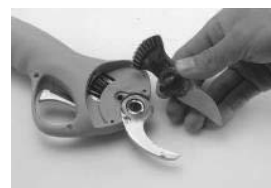
4. Dévisser la goupille et retirer la lame mobile.
