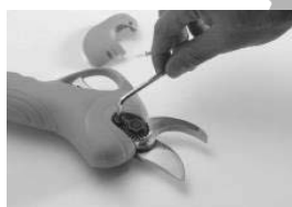
2. Uklonite vijke s držača matica oštrice (ovo korak je ključan).
