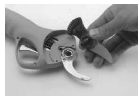
4. Odkręć sworzeń i wyjmij ruchome ostrze
