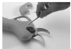
9. Поставете фиксиращата гайка.
