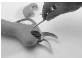
2. Отстранете винтовете от затягаща катарама на гайката на острието (това стъпка е от решаващо значение).
