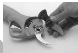
4. Отвийте щифта и свалете движещото се острие
