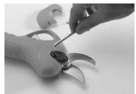
9. Włożyć nakrętkę zabezpieczającą.
