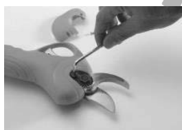
2. Îndepărtați șuruburile de la piuliță de fixare a piuliței lamei catarama de fixare (acest este esențial).
