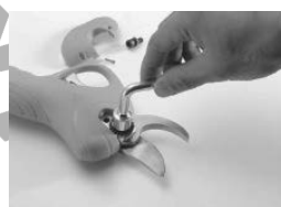
3. Remove the blade nut.
