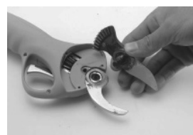
4. Izvijte zatič in odstranite premikajoče se rezilo
