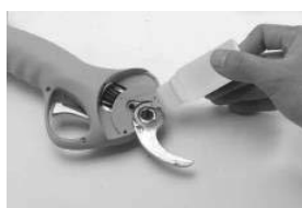
6. Prilikom zamjene oštrica, potrebno je dodati ulje za podmazivanje između.
