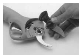
4. Deșurubați știftul și îndepărtați lama în mișcare
