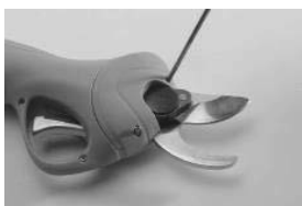
1. Dévisser les vis à l'aide d'un et ouvrir le couvercle.
