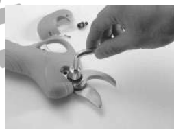
3. Retirer l'écrou de la lame.
