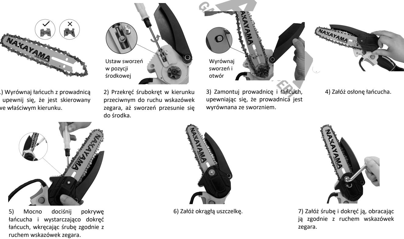
**Uwaga:** Należy często sprawdzać i regulować napięcie łańcucha. Luźny łańcuch jest łatwy do wykolejenia, co może prowadzić do szybkiego zużycia łańcucha i tarczy.
