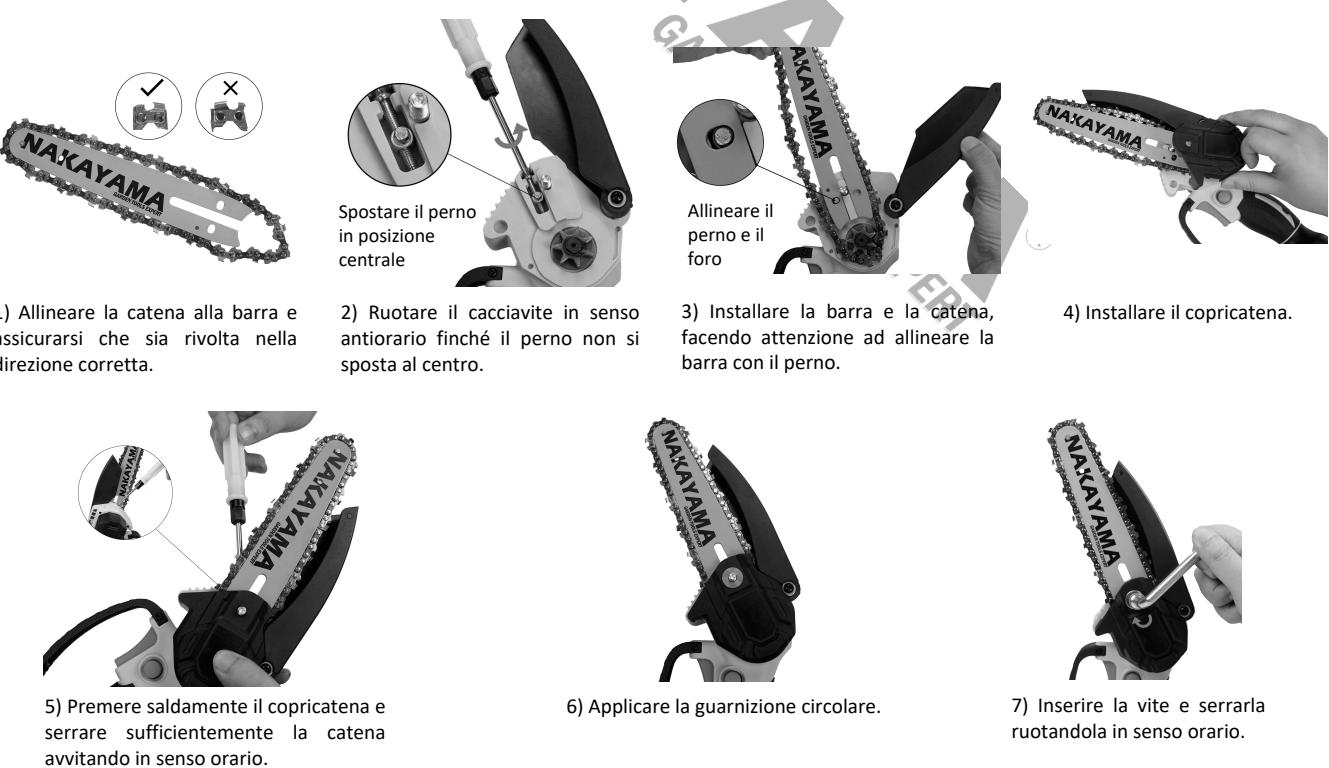
**Nota:** controllare e regolare frequentemente la tensione della catena. Una catena allentata può facilmente deragliare, con conseguente rapida usura della catena e della lama.
