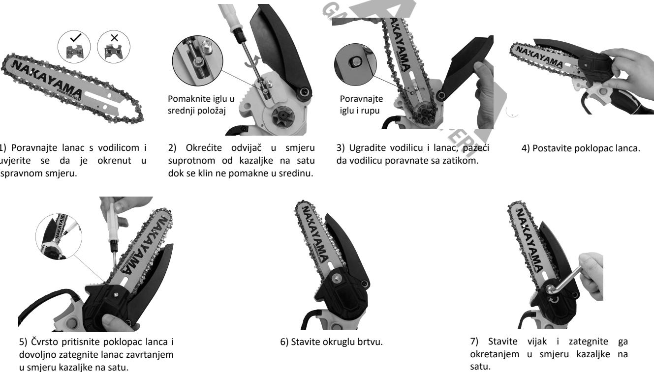
**Napomena:** Često provjeravajte i podešavajte napetost lanca. Labavi lanac lako se izbacuje iz tračnica, što može dovesti do brzog trošenja lanca i oštice.
