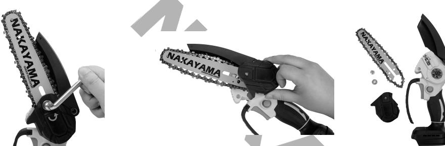
1) Allentare la vite ruotandola in senso antiorario con una chiave.
