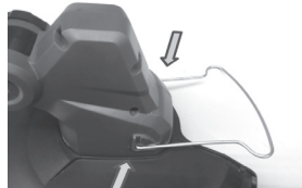
1. Προστατευτικό σύρμα 2. Τρύπες του προστατευτικού 3. Οριακό αυλάκι (θέση λειτουργίας) 4. Οριακό αυλάκι (θέση αδράνειας)
