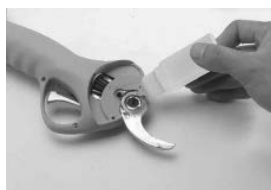
6. Podczas wymiany ostrzy, W międzyczasie należy dodać olej smarujący.
