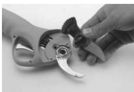
4. Odkręć sworzeń i wyjmij go ruchome ostrze
