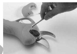
9. Włożyć nakrętkę zabezpieczającą.
