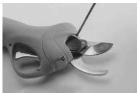
1. Deșurubați șuruburile cu un șurubelniță și deschideți capacul.
