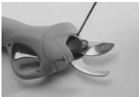
1. Отвийте винтовете с отвертка и отворете капака.
