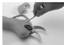
9. Insérez le contre-écrou.
