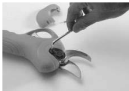
2. Rimuovere le viti dal dado della lama che trattiene la fibbia (questo passaggio è fondamentale).
