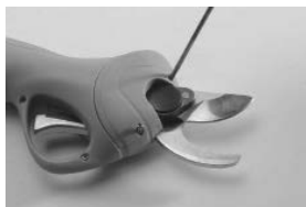
1. Ξεβιδώστε τις βίδες με ένα κατασαβίδι και ανοίξτε το καπάκι.
