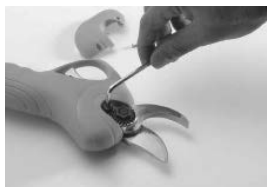
2. Izvadite vijke iz kopče za zadržavanje matice noža (ovaj korak je kritičan).
