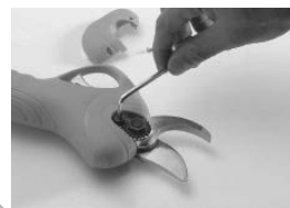
9. Włóż nakrętkę zabezpieczającą.
