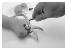
3. Retirez l'écrou de la lame.
