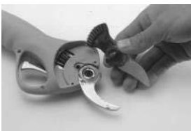
4. Отвийте щифта и извадете движещото се острие
