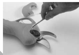
9. Inserire il dado di bloccaggio.
