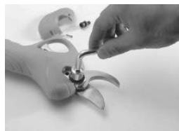
3. Remove the blade nut.
