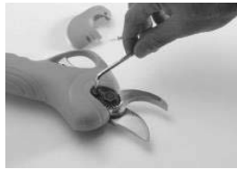
2. Odstranite vijake iz zaponko za pritrditev matice rezila (ta korak je ključnega pomena).
