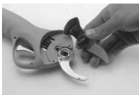
4. Deșurubați știftul și scoateți lama în mișcare.
