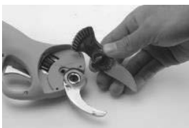
7. Sostituire ogni lama.
