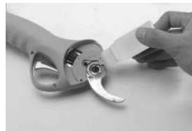
6. Pri zamenjavi rezil, vmes je treba dodati mazalno olje.
