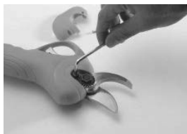
2. Odkręć śruby od klamry mocującej nakrętkę ostrza (ten krok jest krytyczny).
