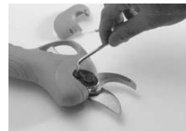
9. Поставете фиксиращата гайка.
