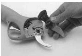
4. Dévissez la goupille et retirez la lame mobile
