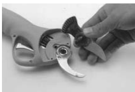
4. Svitare il perno e rimuovere la lama mobile
