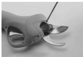
1. Dévissez les vis à l'aide d'un tournevis et ouvrez le couvercle.
