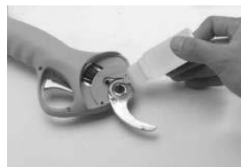
6. При смяна на остриетата, между тях трябва да се добави смазочно масло.
