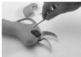
2. Retirez les vis de la boucle de retenue de l'écrou de la lame (cette étape est critique).
